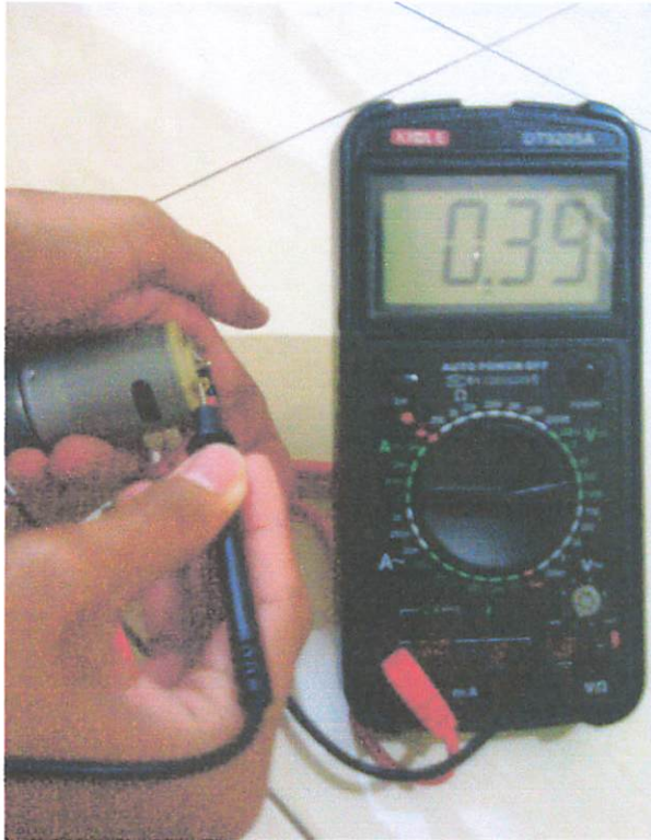
Gambar 4.16 Gambar arus motor DC pada konveyor
