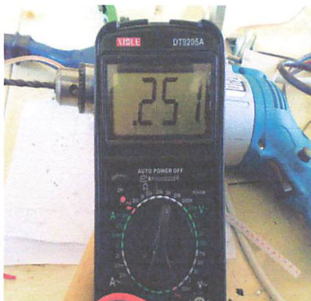
Gambar 4.9 Pengujian Resistansi sensor LDR terhalang telur 6
