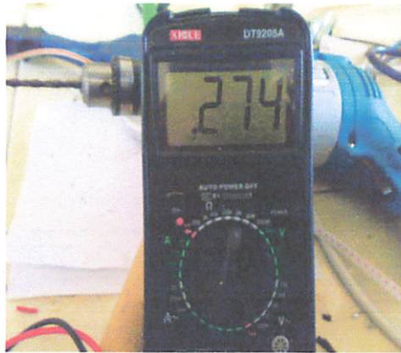
Gambar 4.8 Pengujian Resistansi sensor LDR terhalang telur 5
