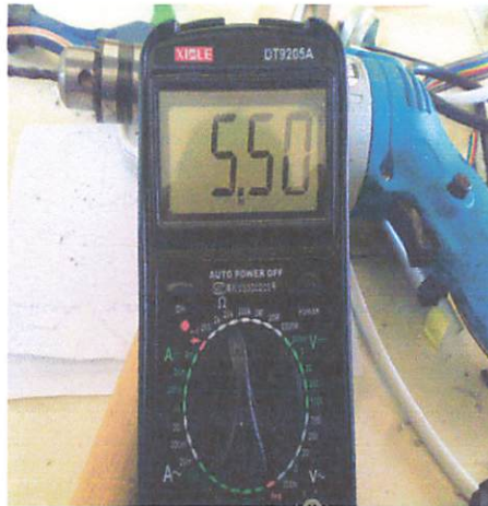
Gambar 4.5 Pengujian Resistansi sensor LDR terhalang telur 2
