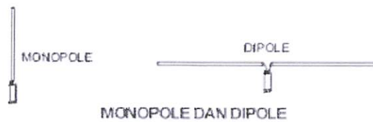
Gambar 3-7 Antenna monopole dan dipole
