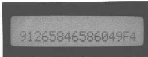
Gambar 4.29. Tampilan LCD Nomor HP Yang Tersimpan Pada EEPROM Dalam Format PDU, Alamat $0D2 - $0E4
