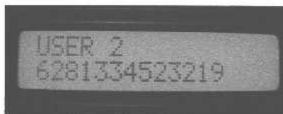
Gambar 4.26. Tampilan LCD Nomor HP Yang Tersimpan Pada EEPROM Alamat $00F - $01C
