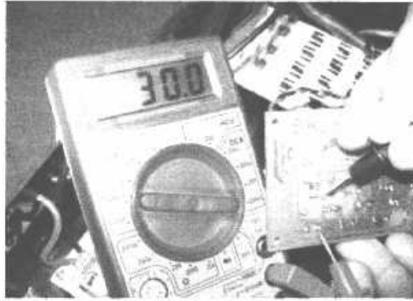
Gambar 4.13. Hasil Pengukuran Arus Ie Trasistor A733
