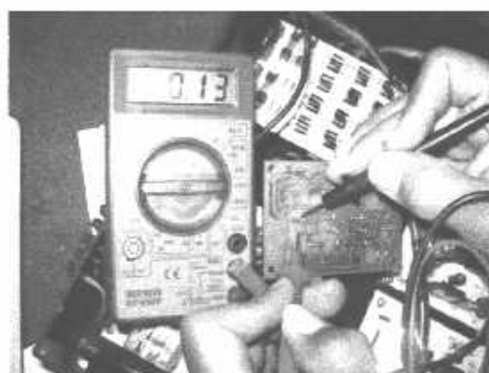
Gambar 4.12. Hasil Pengukuran Arus Ib Trasistor A733
