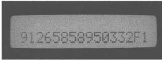
Gambar 4.31. Tampilan LCD Nomor HP Yang Tersimpan Pada EEPROM Dalam Format PDU, Alamat $0FA - $10C
