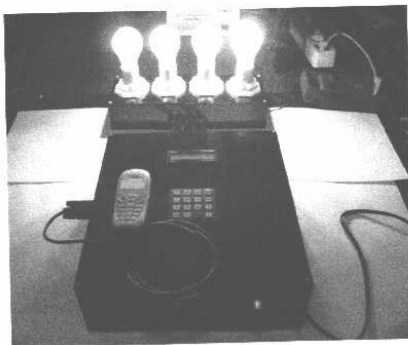
Gambar 4.35. Kondisi Beban Lampu Pijar Setelah Data SMS "ONN 1234" Diterima Sistem
