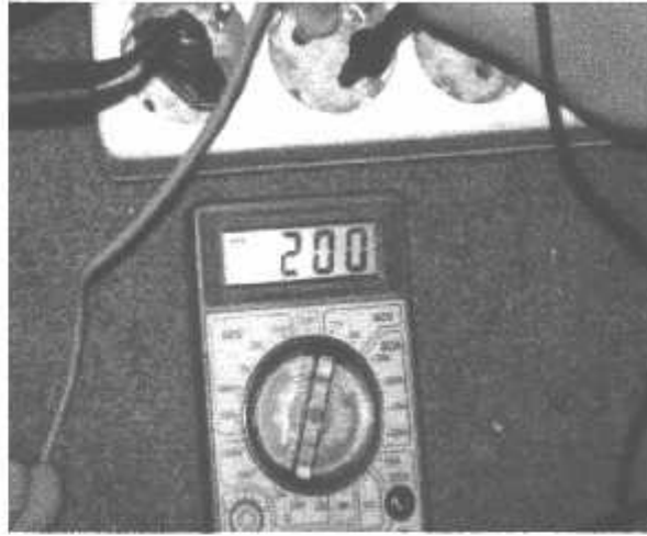
Gambar 4.3. Pengukuran Tegangan Pada Jala-jala Listrik
