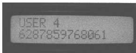
Gambar 4.28. Tampilan LCD Nomor HP Yang Tersimpan Pada EEPROM Alamat $02D - $03A
