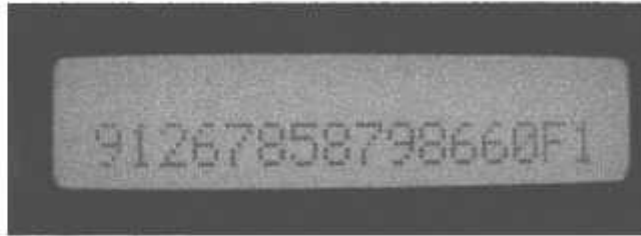
Gambar 4.32. Tampilan LCD Nomor HP Yang Tersimpan Pada EEPROM Dalam Format PDU, Alamat $10E - $120
