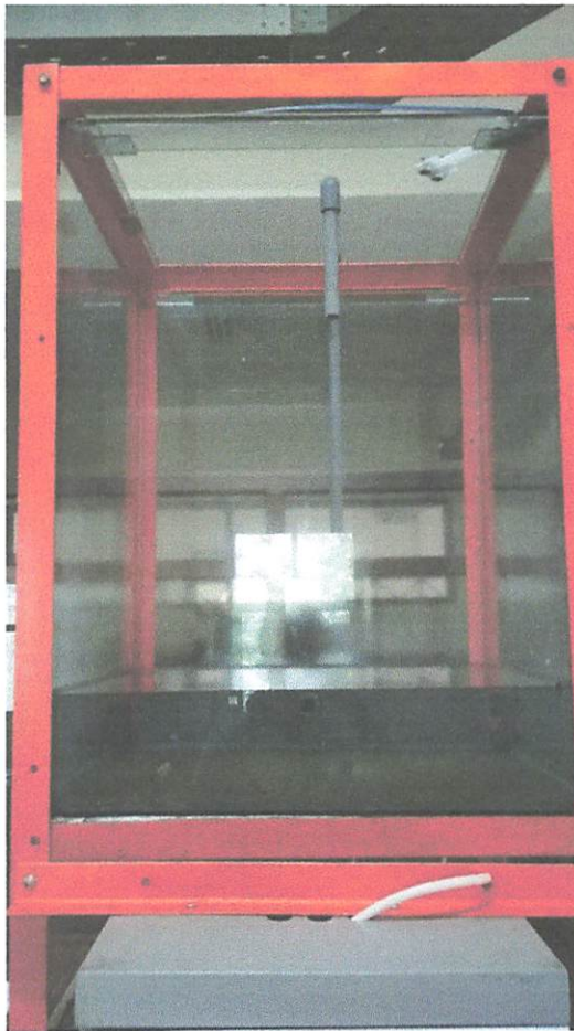
Gambar 4.28 Kondisi Level Air "overflow" pada tandon air
