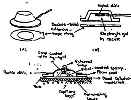
Gambar 2.1. Elektroda noninvasif<sup>(4)</sup>
