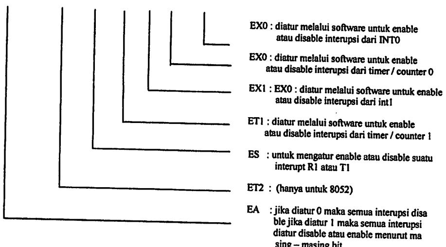
Gambar 2.11. Pendefinisian IE register mikrokontroler AT89C2051
