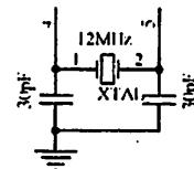
Gambar 3.6 Rangkaian clock Mikrokontroler AT89C2051
