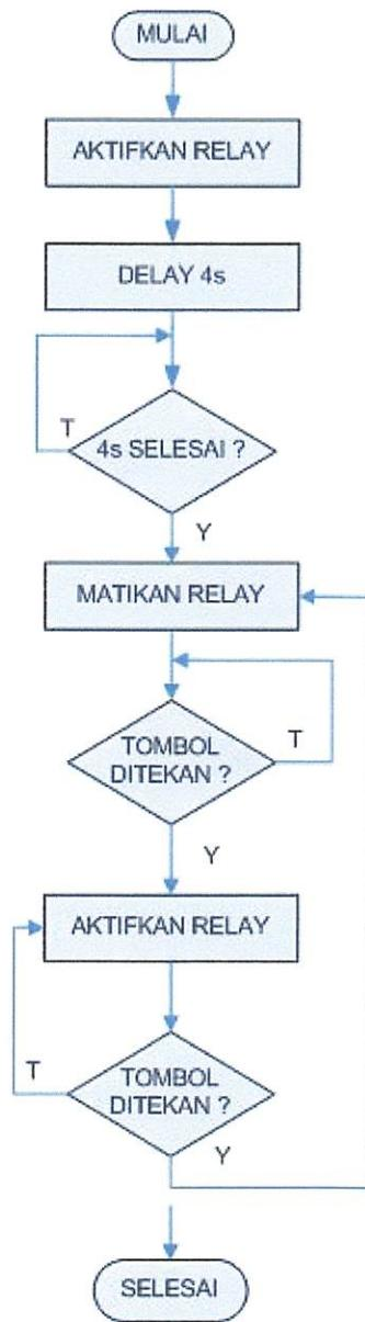
Gambar 3.11. Flowchart mikrokontroler slave
