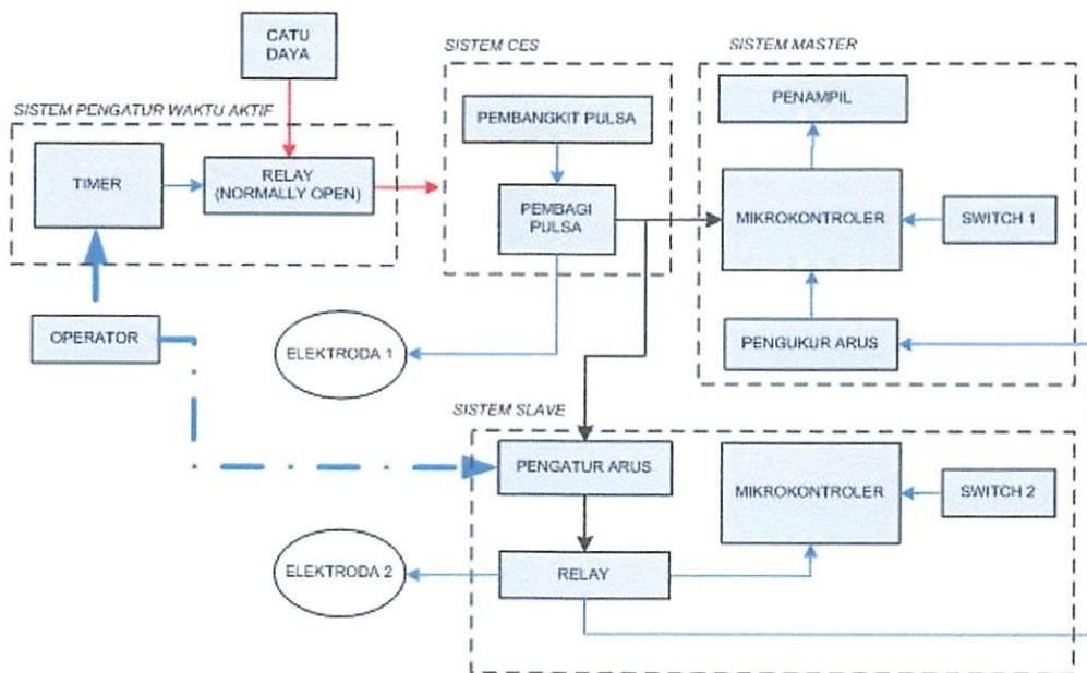
Gambar 3.1. Diagram Blok Alat
