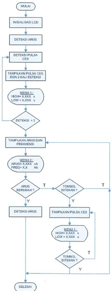
Gambar 3.10. Flowchart mikrokontroler master
