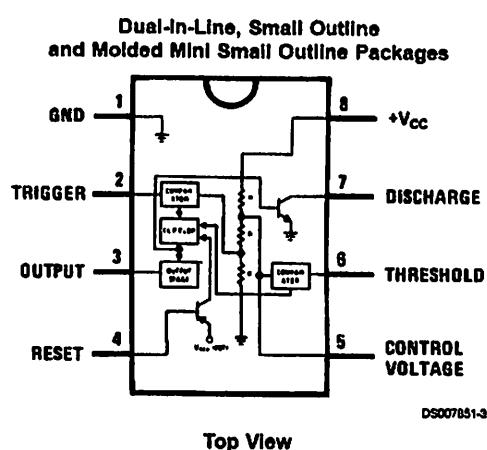
Gambar 2.2. Susunan kaki-kaki IC LM555<sup>(5)</sup>
