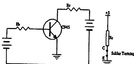
Gambar 2.14. Transistor dalam keadaan Saturasi
