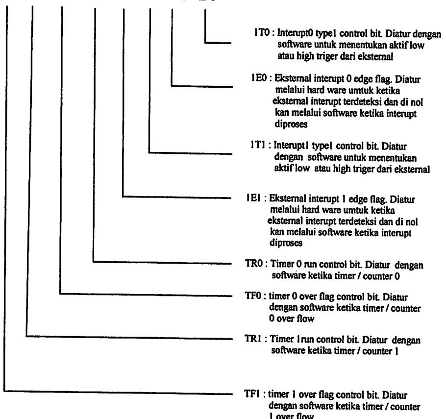
Gambar 2.12. Pendefinisian TMOD mikrokontroler AT89C2051
