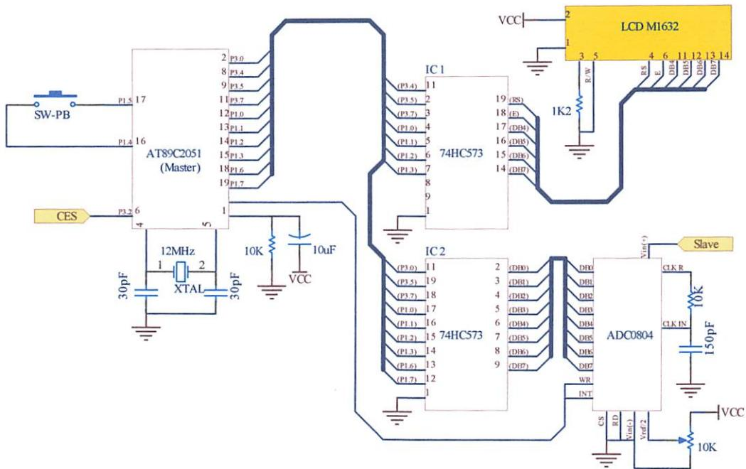
Gambar 3.5. Skematik sistem mikrokontroler master
