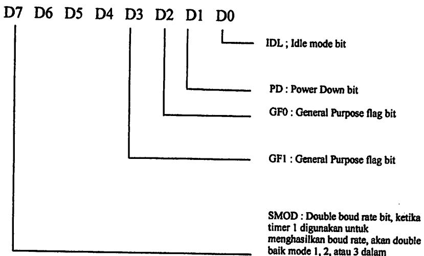
Gambar 2.10. Pendefinisan PCON mikrokontroler AT89C2051
