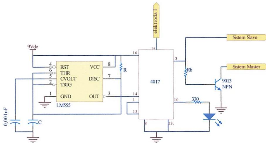
Gambar 3.3. Skematik sistem CES
