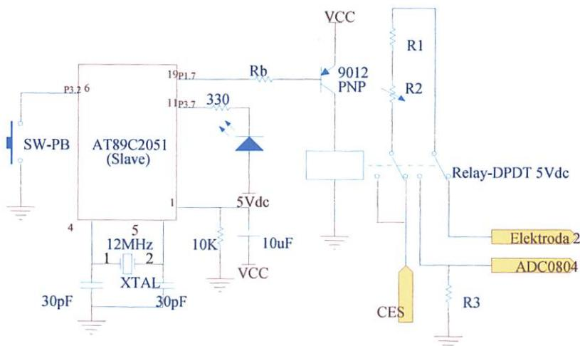
Gambar 3.8. Skematik sistem mikrokontroler slave
