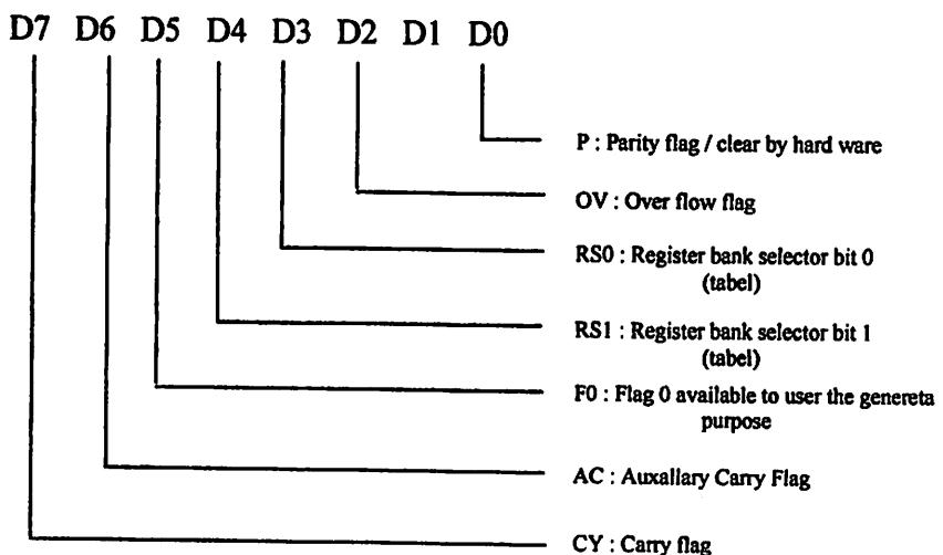
Gambar 2.9. Pendefinisan PSW mikrokontroler AT89C2051
