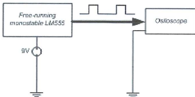
Gambar 4.1. Rangkaian pengujian pembangkit frekuensi LM555
