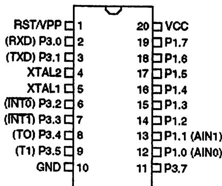
Gambar 2.8. Konfigurasi pin-pin mikrokontroler AT89C2051<sup>[10]</sup>
