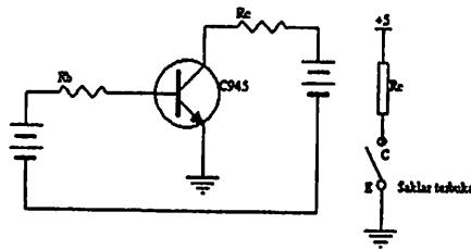
Gambar 2.15. Transistor dalam keadaan Cut Off (sumbat)
