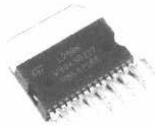
Gambar 2.12 IC driver motor L298
