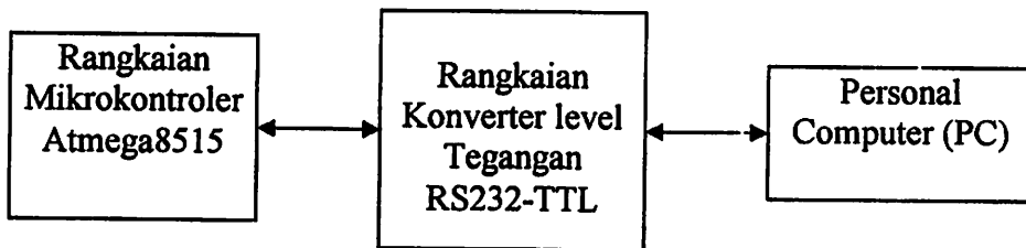
Gambar 4.12 Diagram blok komunikasi antara mikrokontroler dengan PC
