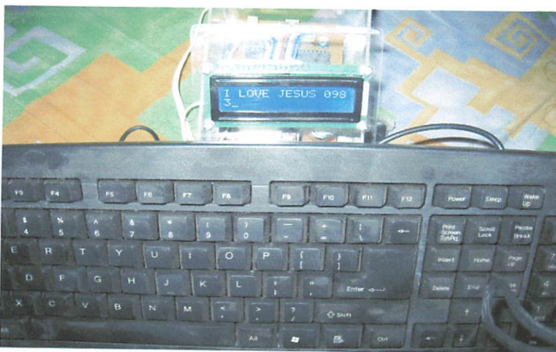
Gambar 4.4 Hasil Pengujian Keyboard PC dan Tampilan pada LCD
