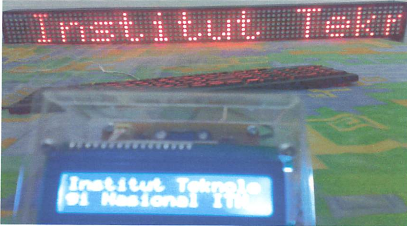
Gambar 4.7 Hasil Pengujian Kelebihan Karakter pada LCD ( Liquid Crystal Display )
