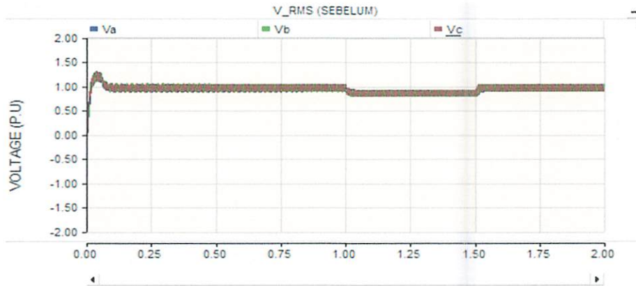
Grafik 4.1 Bentuk gelombang tegangan rms saat terjadi Voltage Sag sebelum dikompensasi DVR
