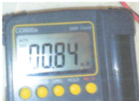
Gambar 4.7. Pengukuran arus saat pengisian baterai menggunakan solar cell
