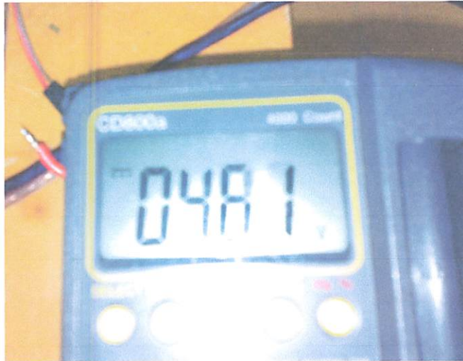
Gambar 4.2. Output dari regulator menggunakan IC 7805
