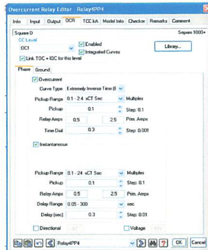
Gambar 4.3 setting relay pada ETAP
