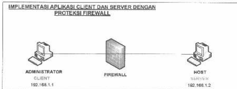
Gambar 4.19 Implementasi dengan Proteksi Firewall
