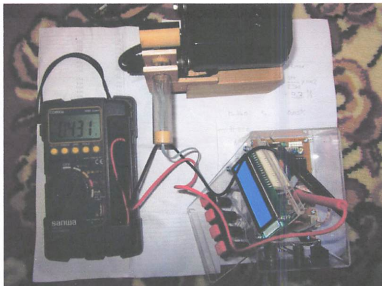
Gambar 4.6 Pengujian sensor photodiode dalam kondisi gelap
