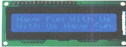
Gambar 2.12. LCD(*Liquid Crystal Display*)
