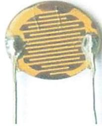
Gambar 2.10. LDR(*Light Dependent Resistor*)
