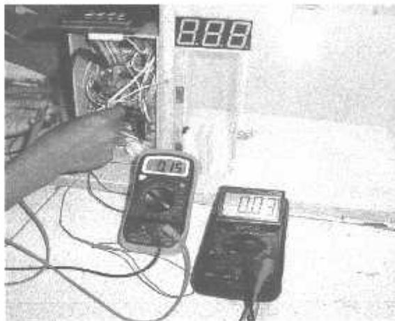
Gambar 4 – 1 Foto Pengukuran Tegangan saat Photodioda
