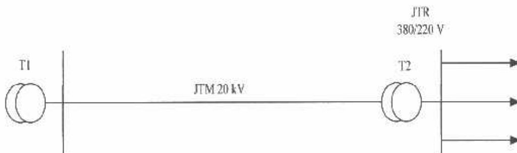
Gambar 2-3. Bentuk Sederhana Dari Sistem Distribusi Radial
