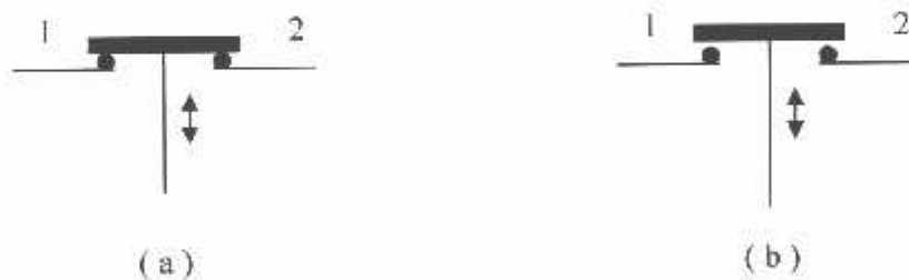
Gambar 3-2 Diagram Skematik Tipe (a) NC switch dan (b) NO switch
