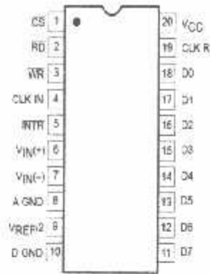
Gambar 2.2 konfigurasi pin IC ADC 0804
