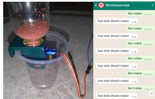
Gambar 4.4 Tampilan Pengujian Mekanik Pakan Ikan
