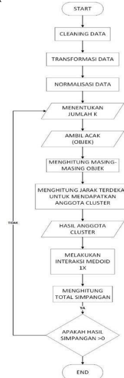
Gambar 3.4 Flowchart Sistem Clustering Pada flowchart tersebut merupakan cara penulisan algoritma dengan menggunakan notasi garis. Flowchart merupakan gambar atau bagan yang memperlihatkan urutan atau langkah-langkah dari suatu program dan hubungan antar proses beserta pernyataannya. Gambaran ini dinyatakan dengan simbol. Dengan demikian setiap simbol
