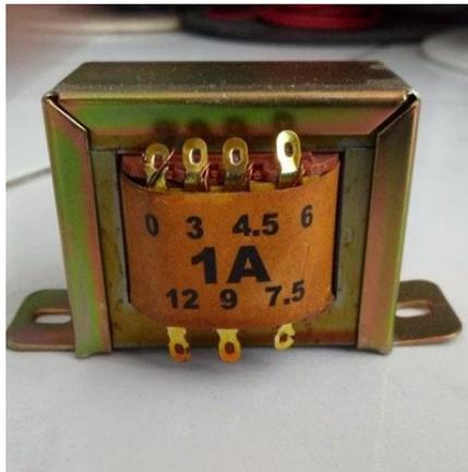
Gambar 2.18 Trafo Step Down 1 A
