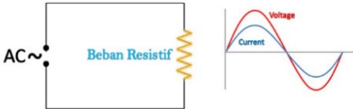
Gambar 2.4 Skematik Diagram Kerja Beban Resistif
