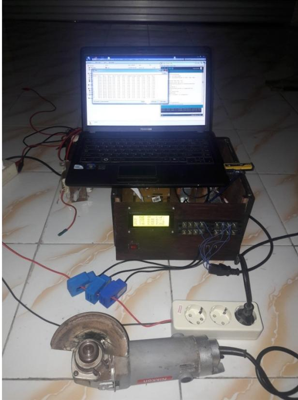
Gambar 4.15 Tampilan Keseluruhan Untuk beban Induktif Dengan Gerinda
