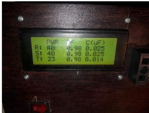
Gambar 4.6 Tampilan Lcd Pada Beban Lampu Pijar 40 Watt
