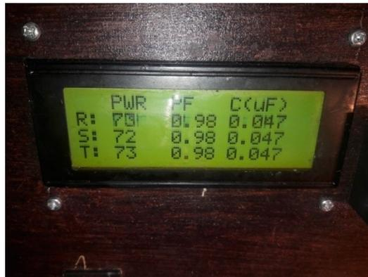
Gambar 4.8 Tampilan Lcd Pada Beban Lampu Pijar 100 Watt
