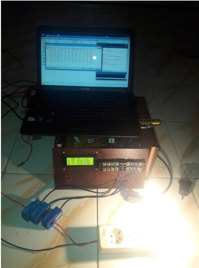
Gambar 4.14 Tampilan Keseluruhan Untuk Beban Resistif Dengan Lampu Pijar 40W dan 100W
