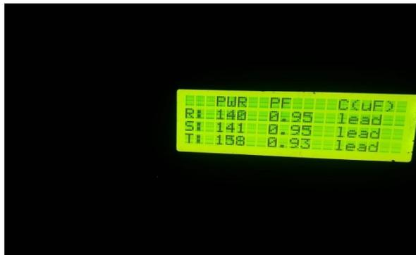
Gambar 4.12 Tampilan Lcd Pada Beban Capacitor 12.5  $\mu F$
