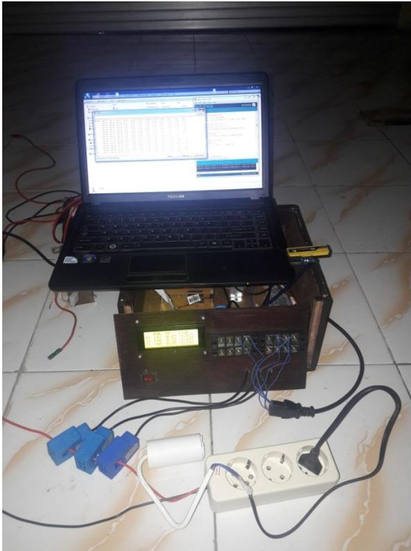
Gambar 4.16 Tampilan Keseluruhan Untuk Beban Kapasitif Dengan Capacitor  $12.5 \mu F$
