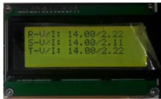
Gambar 10. Gambar Arus Dan Tegangan Pada Pengujian LCD
