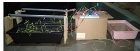
Gambar 4.15 Tampilan Pengujian *Prototype Alat Penyiraman Kangkung*
