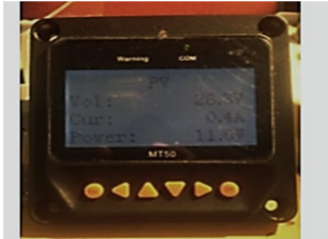
Gambar 4.5 Tampilan Pada Indikator PV pada di splay Charger Control
