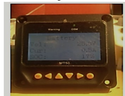
Gambar 4.3 Tampilan Indikator Baterai pada display Charger Control
