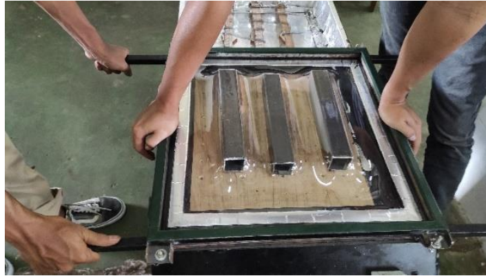
Gambar 3.44 Akrilik yang sudah mengikuti bentuk moulding (Sumber : Dokumen pribadi)
