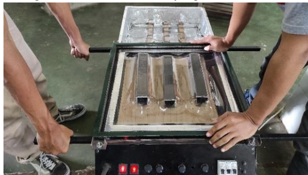
Gambar 3.43 Proses pemvakuman akrilik (Sumber : Dokumen pribadi)
