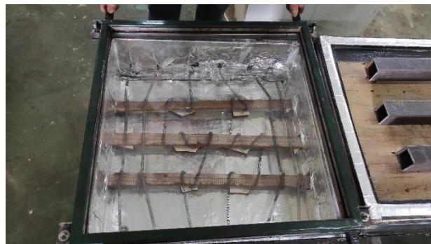
Gambar 3.39 Peletakan akrilik diatas heater (Sumber : Dokumen pribadi)
