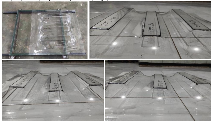
Gambar 3.46 Akrilik yang sudah dilepas dari penjepit (Sumber : Dokumen pribadi)
