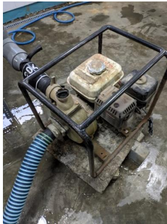
Setting pompa air ke selang dan pipa aliran air
