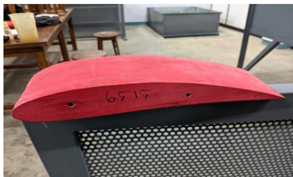
Sudu Naca setelah di pylox permukaannya
