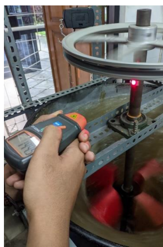
Proses pengambilan data rpm dan pembebanan torsi
