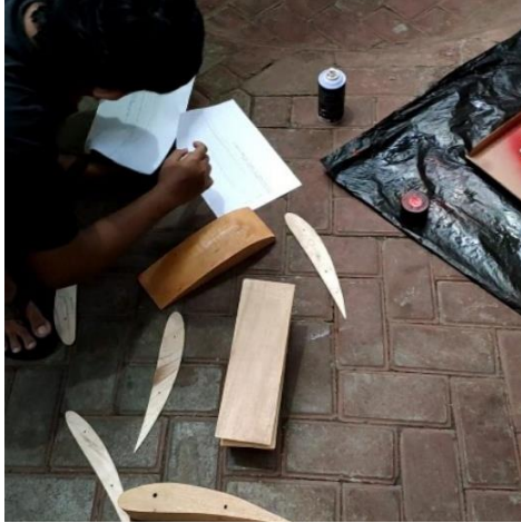
Proses pencocokan mal sudu naca dan pylox pada bagian permukaan
