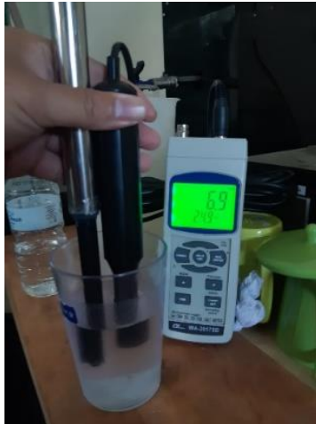
Gambar 4.1 Pengujian antara sensor oksigen standar dengan sensor oksigen SKU SEN0237
