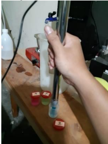
Gambar 4. 2 Pengujian antara sensor pH dengan buffer pH standar
