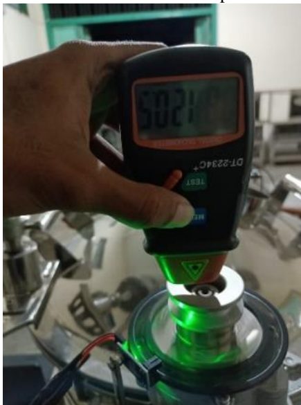
Gambar 4. 4 Pengujian penembakan tachometer ke motor
