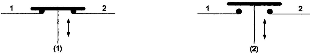
**Gambar 2-8. Diagram Skematik Tipe (1) NC Switch dan (2) NO Switch**
