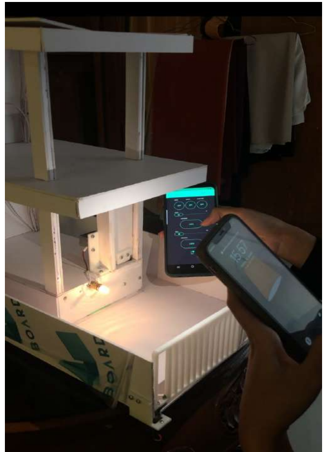
Gambar 4.17 Pengujian Sensor LDR Setelah Terdapat Cahaya
