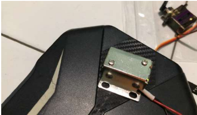
Gambar 4.13 Tombol Unlock ditekan, Solenoid Membuka Kunci
