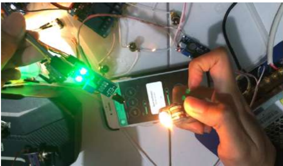
Gambar 4.6 Pengujian Sensor Api Sesudah Terdapat Api dan Muncul Notifikasi Blynk
