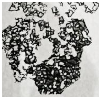
Gambar 2. 8 Struktur Mikro Sementit Pembesaran 500x
