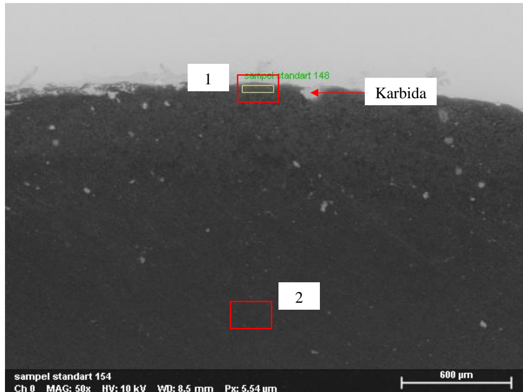
Gambar 4. 4 Sampel yang diambil pada perlakuan karburisasi 700°C dengan waktu penahanan selama 3 jam.
