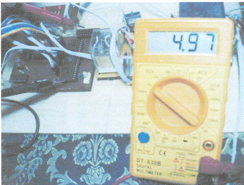
Gambar 4-12. Tegangan Output Pada Kondisi Motor Reflektor Diam
