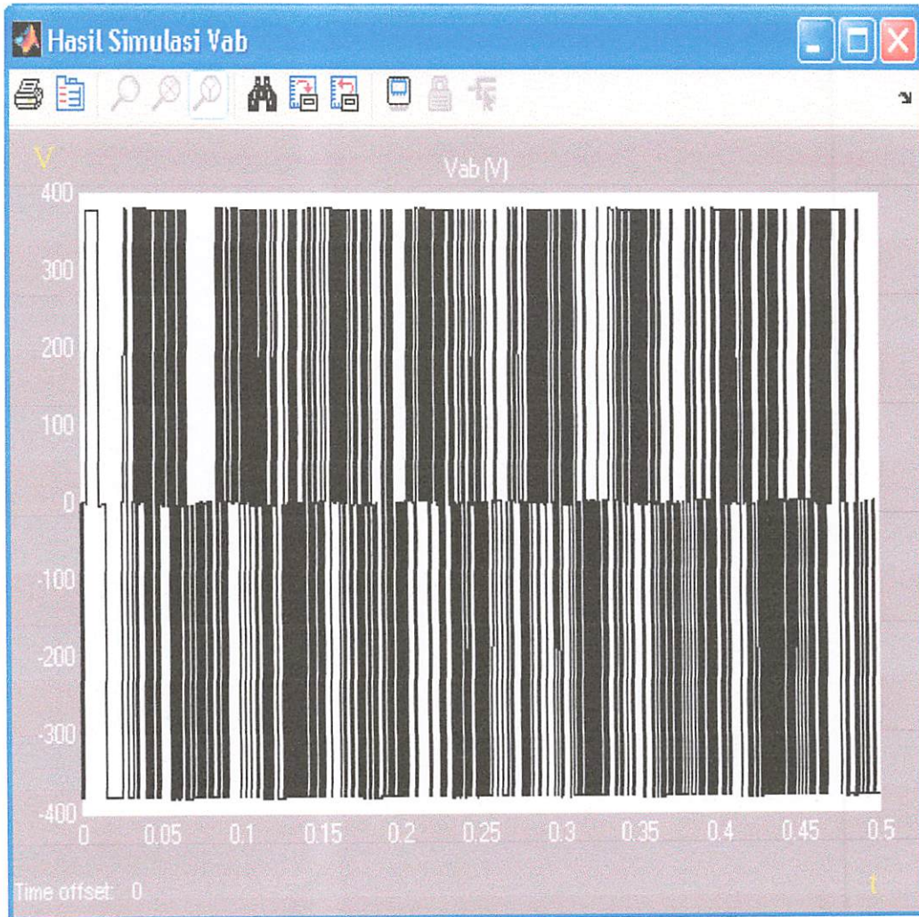
Gambar 4.5 Hasil Simulasi Tegangan Motor Pada Setting Point 500 rpm Tanpa Beban
