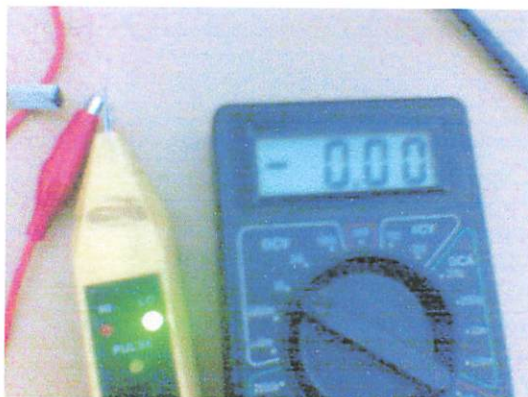
Gambar 4.8 Pengujian pada Optocoupler pada Saat terhalang
