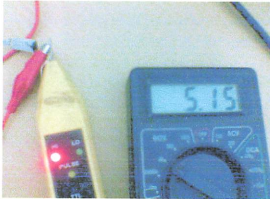
Gambar 4.7 Pengujian pada Optocoupler saat tidak terhalang
