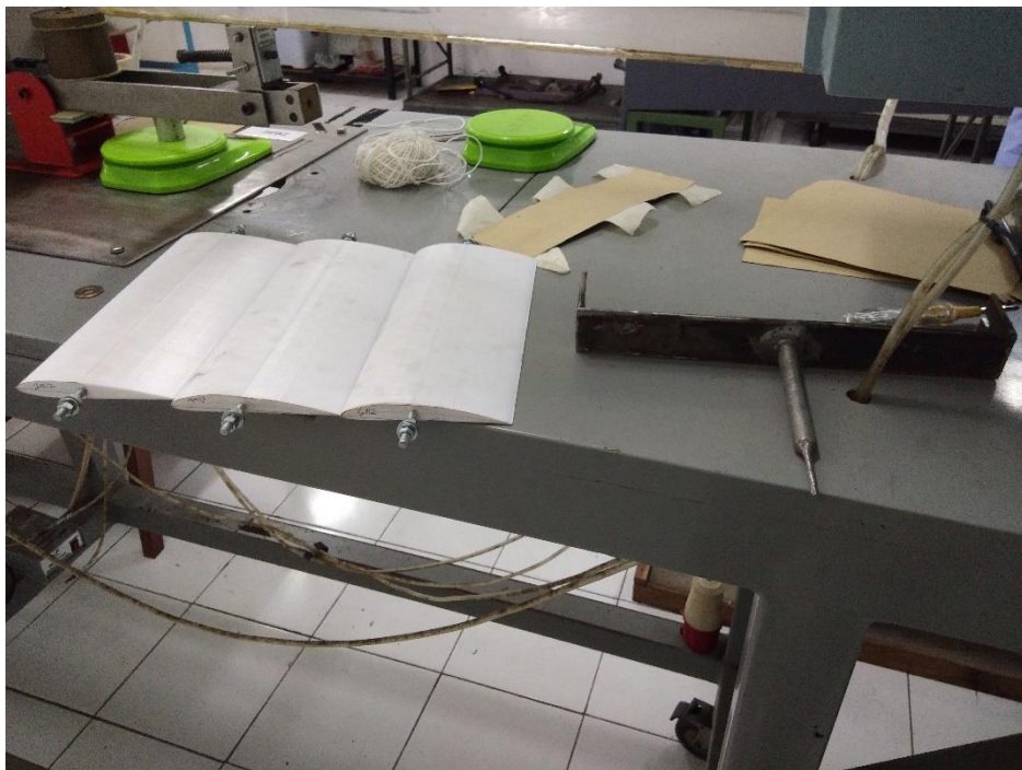
Gambar 3.6 Spesimen dan dudukan airfoil
