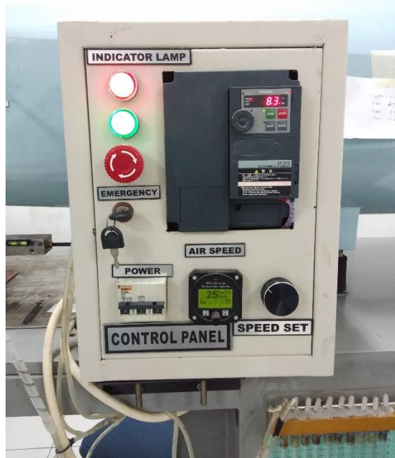
Gambar 3.9 Mengatur kecepatan aliran angin
