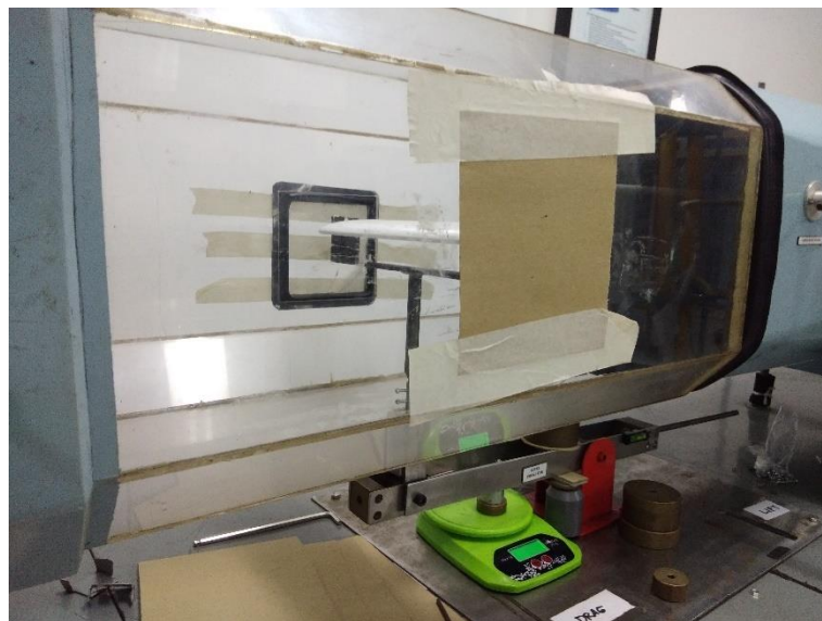
Gambar 3.8 Keadaan airfoil setelah terpasang
