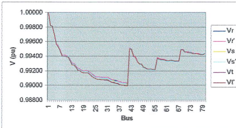
Grafik 4-9: Keadaan Tegangan Sebelum dan Sesudah Terpasang TCSC di Saluran 28 – 30 pada Fasa R, S dan T
