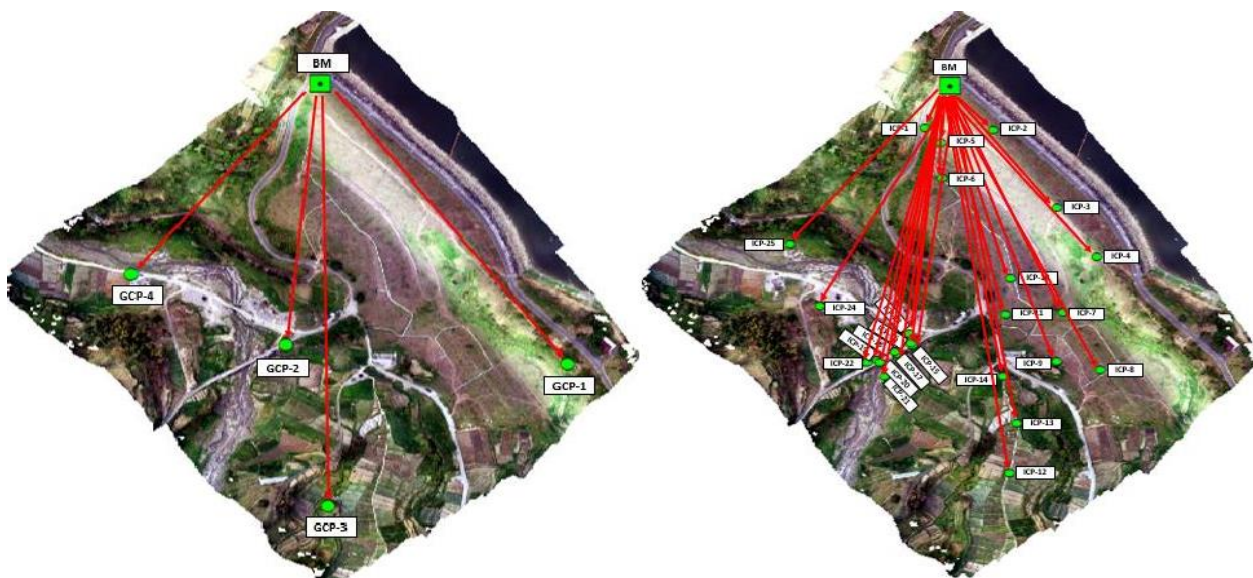
Gambar 8. Persebaran titik GCP (kiri) dan titik ICP (kanan), serta desain pengikatan terhadap BM
