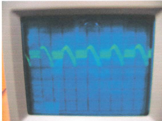
Gambar 4.37. Hasil Eksperimen Gelombang Vdc Pada sudut pemicuan SCR ( \alpha^0 ) = 45^0
