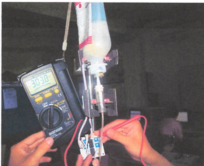
Gambar 4.5 Pengujian rangkaian detektor saat cairan dalam botol infus masih ada.
