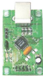
Gambar 2.4 Modul FT232BM (Sumber : Data Sheet FT232BM)
