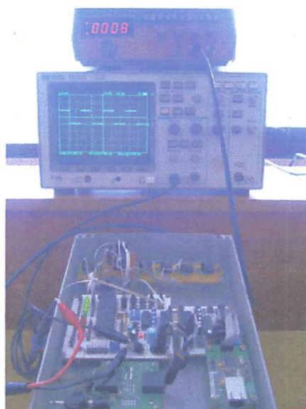
Gambar 4.11 Menghubungkan rangkaian mikrokontroler dengan function generator
