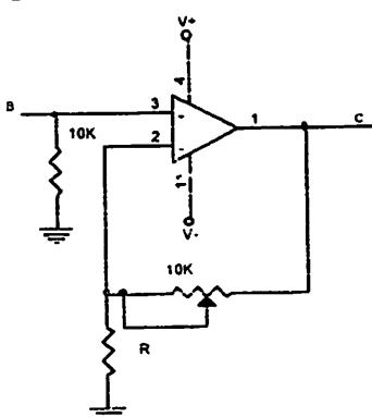
Output DAC ini masih dapat dinaikkan ke level yang lebih besar tergantung dari besar tegangan supply yang digunakan. Tegangan output ini maksimal 1,5V dibawah tegangan supply positifnya. Rangkaian dasar penguat tegangan adalah penguat tegangan tidak membalik seperti dalam gambar berikut
