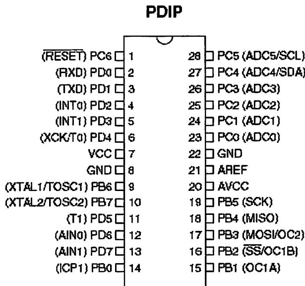
**Gambar 2.4 Konfigurasi Pin ATmega8<sup>[2]</sup>**
