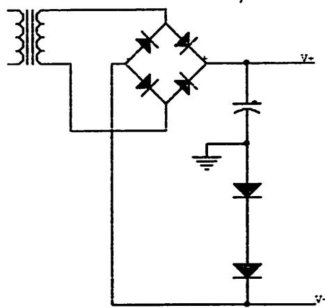
Pada bagian ini, tegangan  $-V$  dibutuhkan untuk menghasilkan respon yang lebih linier dari Op Amp yang digunakan.
