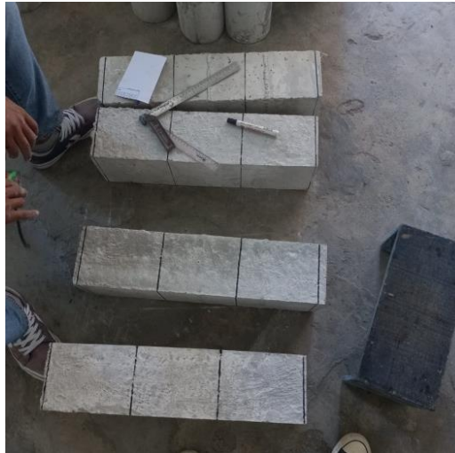
Pembagiann Zona Patahan Sebelum Dilakukan Pengujian Kuat Lentur
