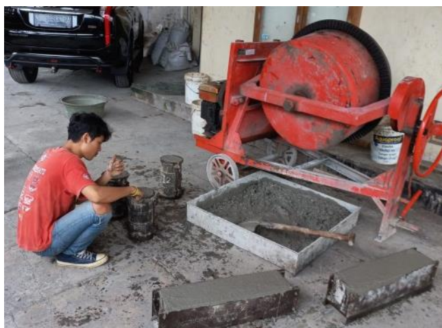
Penuangan Beton Segar Pada Cetakan
