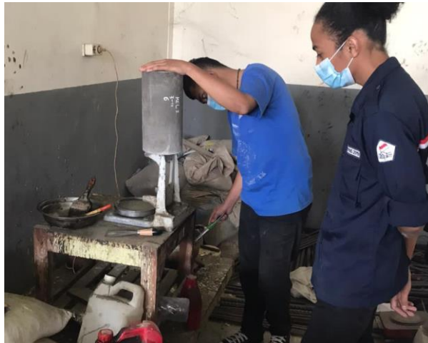
Pemberian Capping Pada Bagian Atas Benda Uji Yang Tidak Rata
