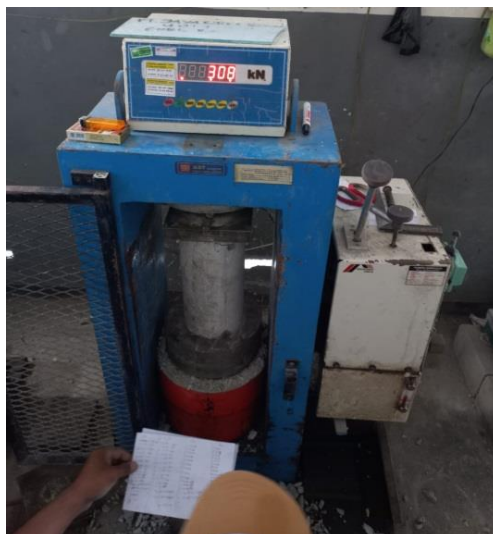
Pengujian Kuat Tekan
