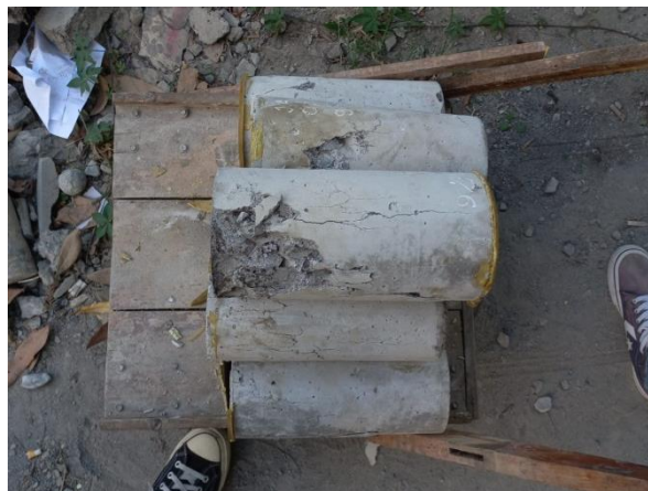
Sampel Benda Uji Setelah Dilakukan Pengujian
