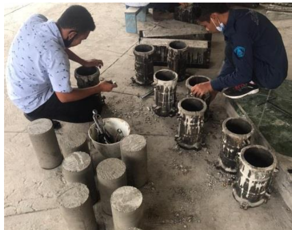
Proses Pembongkaran Benda Uji dari Cetakan dan Pembersihan Cetakan Serta Pelumasan Kembali
