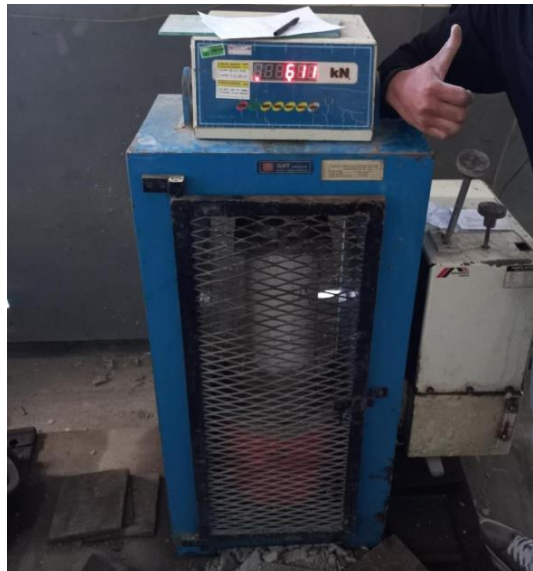
Pengujian Kuat Tekan
