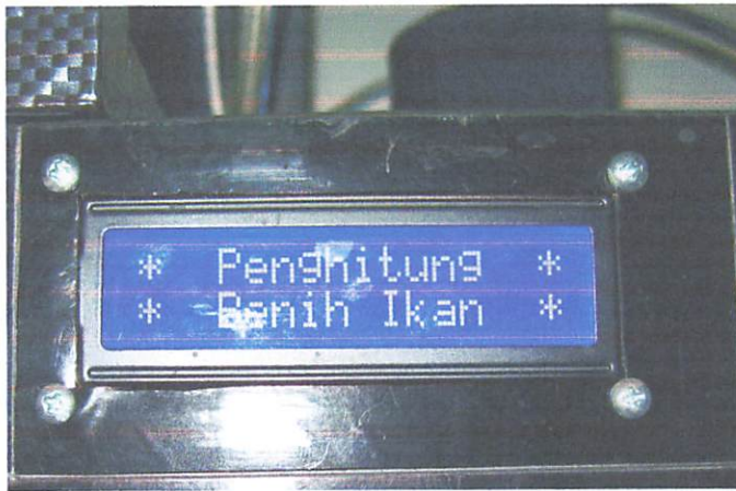
Gambar 4.7. Pengujian tampilan LCD
