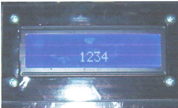
Gambar 4.9 Hasil pengujian keypad dengan tampilan LCD
