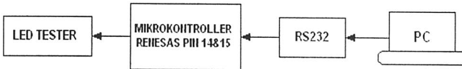
Gambar 4-4 Blok Pengujian Komunikasi serial dari PC ke Mikrokontroller
