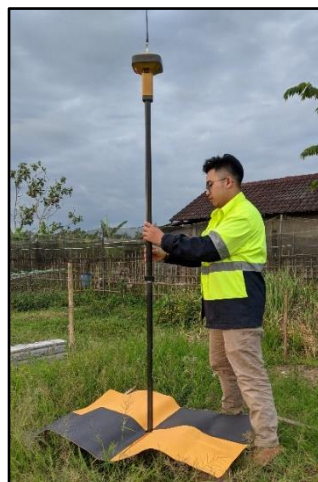
Gambar 2. Pengukuran ICP Metode RTK NTRIP
