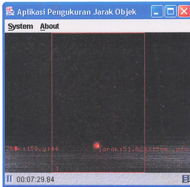
Gambar 4.5 Form program pengujian triplek pada jarak aktual 40 cm
