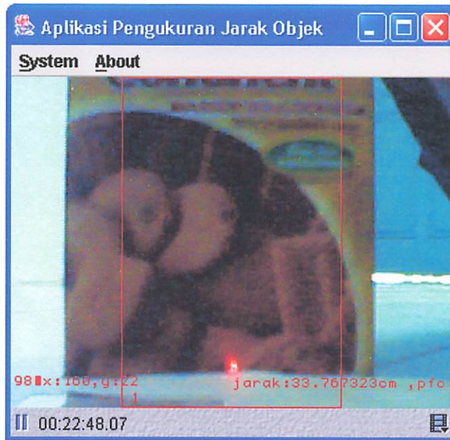
Gambar 4. 12 Form program pengujian kaleng pada jarak aktual 35 cm
