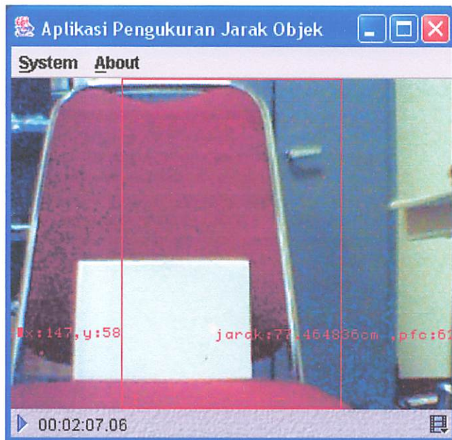
Gambar 4.7 Tampilan form program pengujian pada jarak actual 77.5 cm
