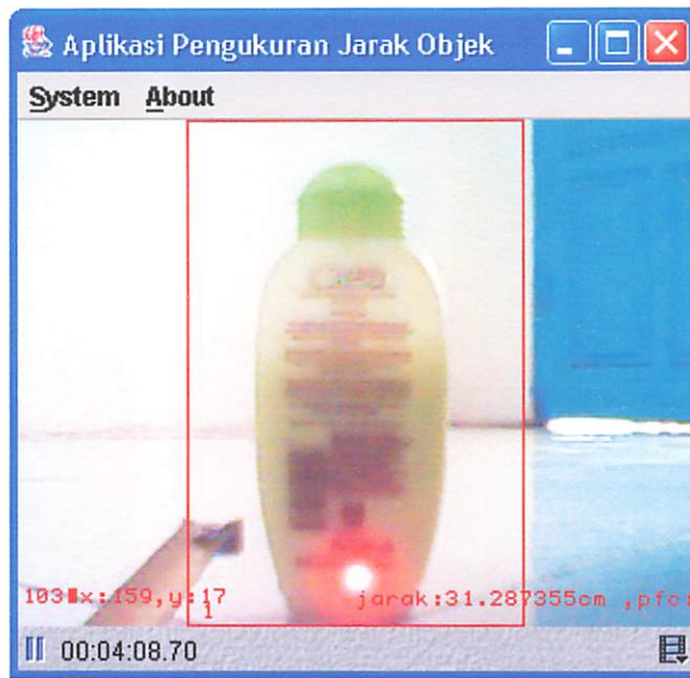
Gambar 4. 7 Form program pengujian plastik pada jarak aktual 30 cm
