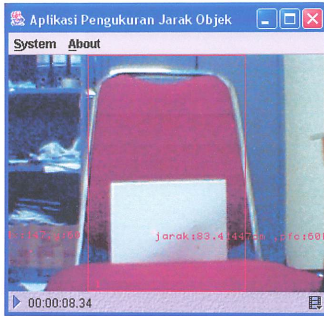
Gambar 4.8 Tampilan form program pengujian pada jarak actual 84 cm
