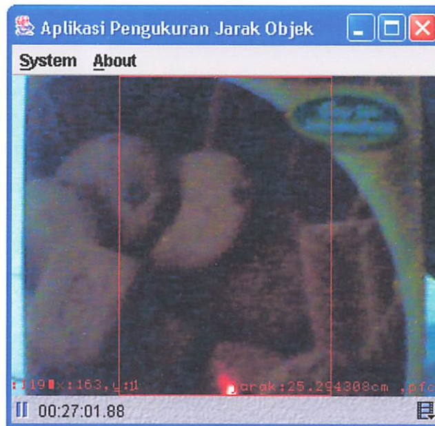
Gambar 4. 10 Form program pengujian kaleng pada jarak aktual 25 cm
