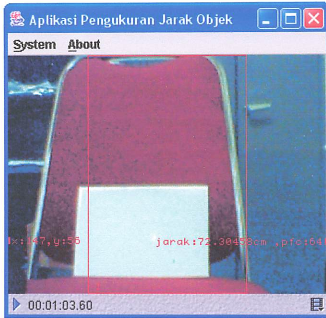
Gambar 4.6 Tampilan form program pengujian pada jarak actual 72.5 cm
