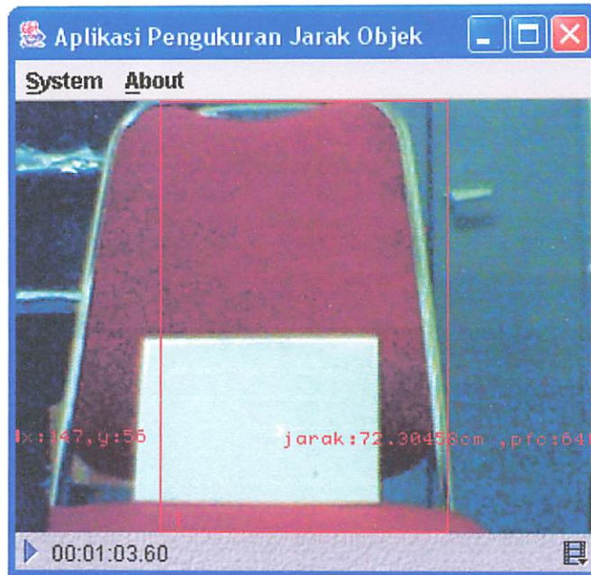
Gambar 3-11. Gambar yang ditangkap webcam serta informasi jarak
