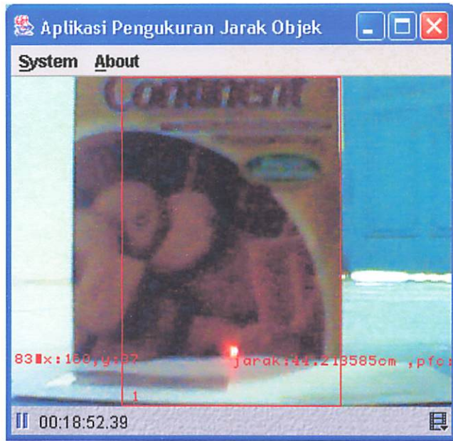
Gambar 4. 13 Form program pengujian kaleng pada jarak aktual 40 cm
