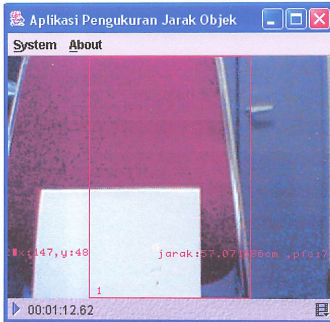
Gambar 4.4 Tampilan form program pengujian pada jarak actual 59 cm
