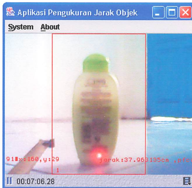
Gambar 4. 8 Form program pengujian plastik pada jarak aktual 35 cm
