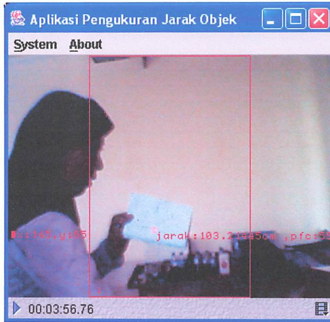
Gambar 4.10 Tampilan form program pengujian pada jarak actual 104.5 cm
