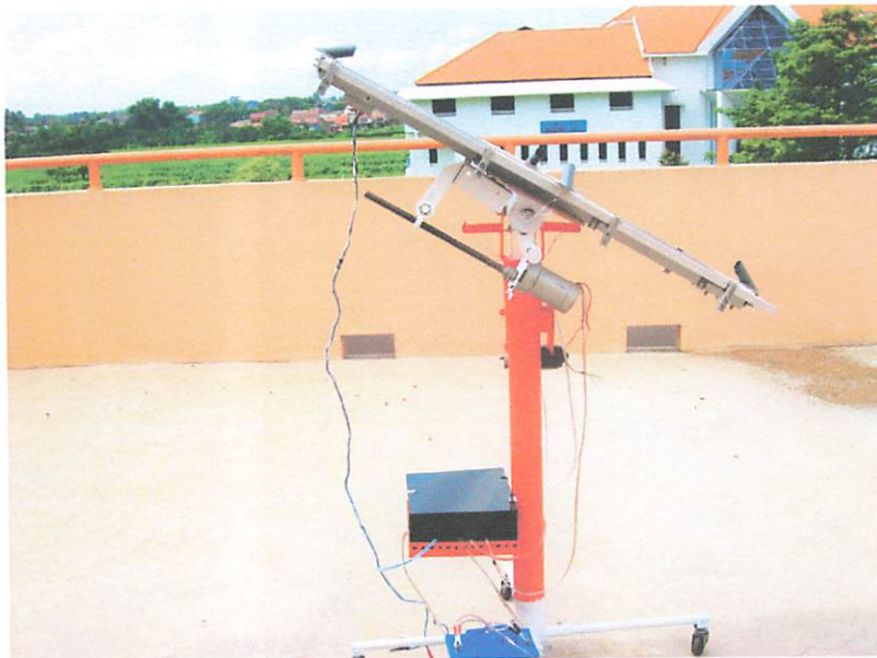
Gambar 4.18. Alat Kontrol Modul Sel surya Arah Barat
