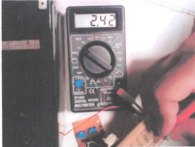
Gambar 4.7. Hasil Pengujian Tegangan Referensi Pengkondisi Sinyal
