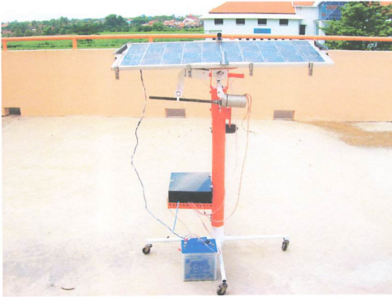
Gambar 4.19. Alat Kontrol Modul Sel surya Arah Utara
