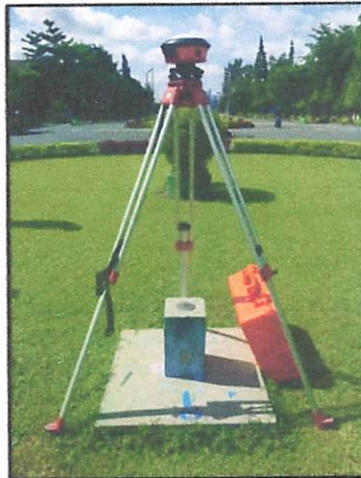
Gambar 3.3 Mendirikan DGPS Land-Pak di BM N0005
