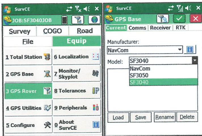
Gambar 3.14 Proses seting Rover Pemilihan tipe Alat
