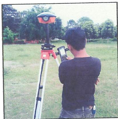
Gambar 3.10 Mendirikan DGPS Land-Pak sebagai Rover
